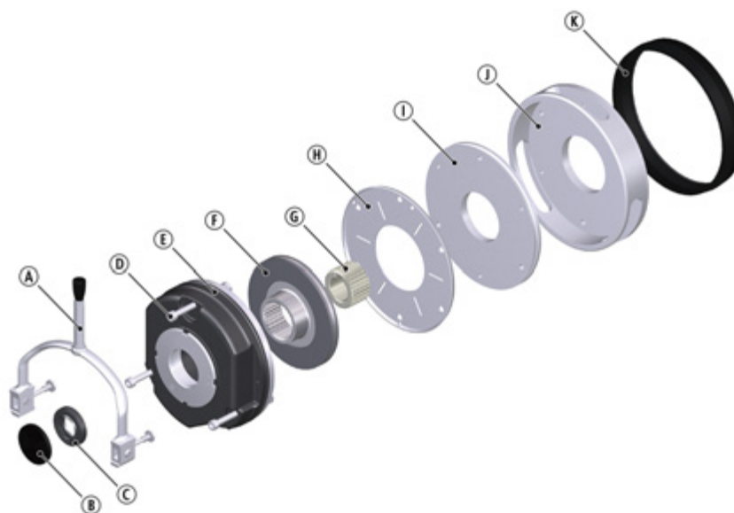
Abb. 34: Federkraftbremse INTORQ BFK458-06 bis 25
